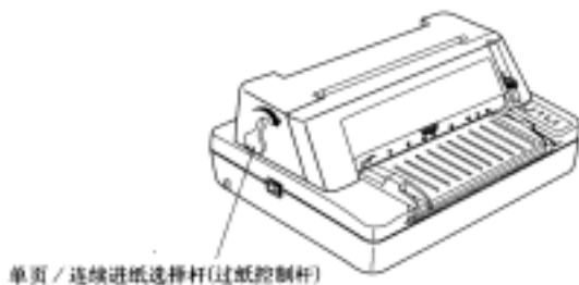
图 3-8 使用进纸方式选择杆
